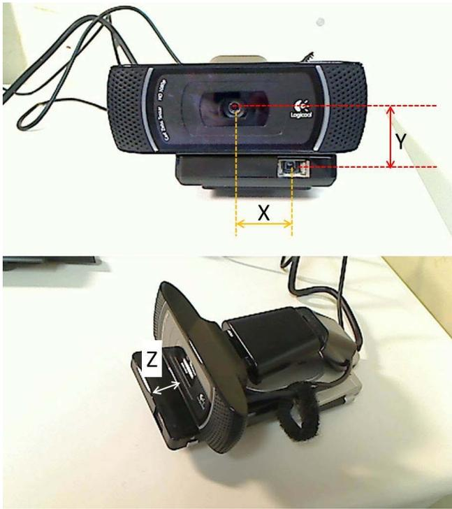
図 4 プロジェクタとカメラの距離
