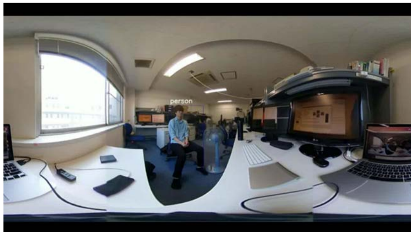
図 2: 正距円筒図法での物体検出例
